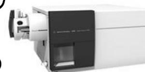
構成: MS部本体/G6490A、LC部/G1379B マイクロプレカッサ、G1312B ハイナリホップ、G1367E オートサンブラ、G1330B 冷却モジュール、G4212B ダイオードアレイ検出器、G1316A カラムコンパートメント、トレイ、G4208A インスタントパイロット
