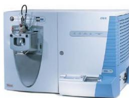
構成: LTQ XL 本体、HESI-IIプローブ、ASPIプローブ、島津LCシステム/DGU-20A3、LC-20AD×2、SIL-20ACHT、CTO-20A、CBM-20A、SPD-M20A
