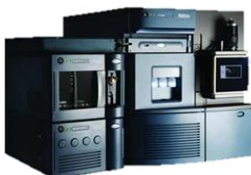
構成: タンDEM四重極型質量分析装置、ソルベントマネージャ、サンプルマネージャ、カラムヒーター、PDA検出器、窒素ガス発生装置、PCセット
