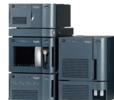
構成: タンDEM四重極型質量分析装置、ソルベントマネージャ、サンプルマネージャ、サンプルオーガナイザ、PDA、カラムヒーター、窒素ガス発生装置、トランス、PCセット
