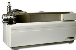
構成: API4000 LC/MS/MSシステム、Shimadzu UFLC
