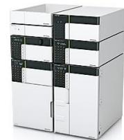
構成: 送液ユニット LC-201AD、オンラインデガッサー DGU-20A3R、カラムオープン CTO-20A、オートサンプラー SIL-20AHT、システムコントローラ CBM-20A、UV-VIS検出器 SPD-20AV、示差屈折率検出器 RF-20Axs、リザーバトレイ、PCセット
