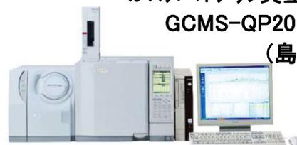
構成: MS部 GCMS-QP2010 Ultra SYSTEM、GC部 GC-2010 Plus、オートインジェクタ AOC-20i、オートサンプラ AOC-20s、真空ポンプ EDWARDS E2M-1.5、PCセット
