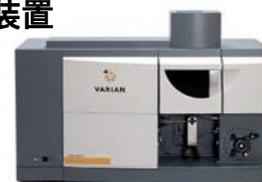
構成: 730-ES 本体、オートサンプラー SPS3、冷却水循環装置
