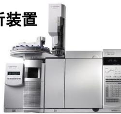
構成: 5975C 質量検出器、7890A GCシステム、7693A サンプルインジェクタ(150サンプルトレイ仕様)、PCセット、NIST08 MSライブラリ
